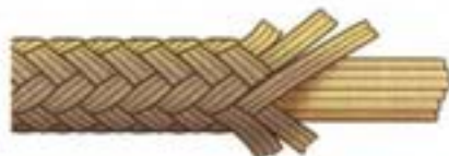
Figure 3 Cordage tressé dont l'âme est constituée de brins parallèles; exemple photographique ci-dessous.
